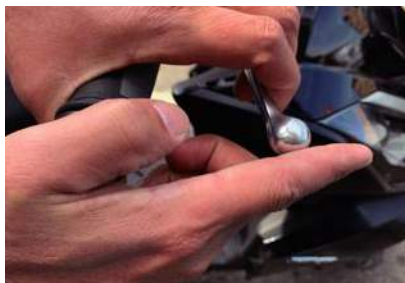
▶ 煞車-拉桿間隔1~2cm
