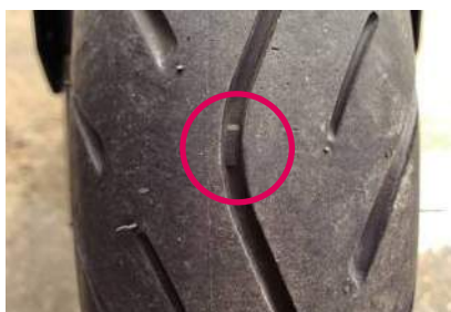
▶ 輪胎胎面-磨耗至指示點即要更換(0.8mm)
